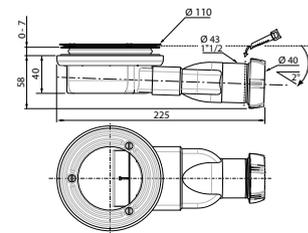
VÁLVULA EXTRAPLANA Ø90 SALIDA HORIZONTAL SLIM + SIN REJILLA PLATO DE DUCHA EXTRAPLANO
