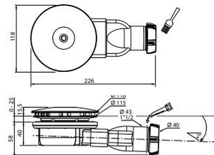
VÁLVULA EXTRAPLANA Ø90 SALIDA HORIZONTAL SLIM + CON REJILLA PLANA DE ACERO INOXIDABLE CEPILLADO
