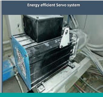
En Afrique du Sud, moulage par compression - remplacement de la pompe à piston conventionnelle par une servo-pompe à engrenages
