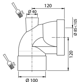
BAGUE avec joint de sortie de cuvette
