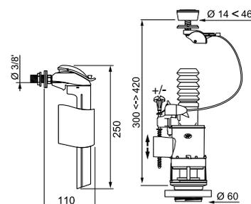
Mécanisme à câble + robinet
