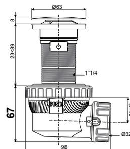
**BONDE Ø 32 écoulement libre avec siphon NANO 6.7**
