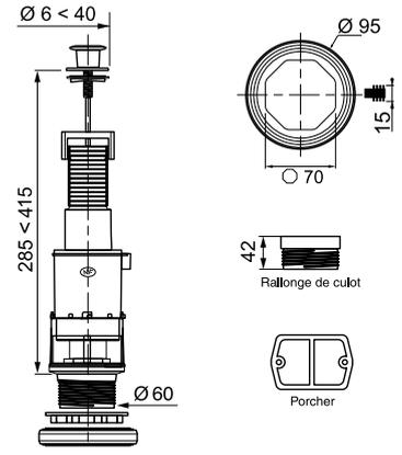
Mécanisme à câble pour personnes à mobilité réduite MD<sup>2</sup> PMR
