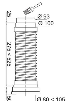
La pipe WC extensible WIRQUIN est la solution idéale lorsqu'il est impossible d'utiliser une pipe WC rigide classique en raison de la disposition des canalisations. Le fil métallique à l'intérieur de la gaine garantit que cette dernière est à l'épreuve du temps.
