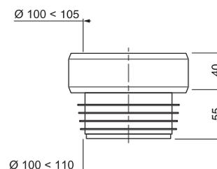
BAGUES DE SORTIE DE CUVETTE AVEC JOINT
