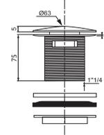
**BONDE à fermeture à clapet rotatif en laiton sans trop-plein**
