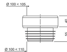
**SORTIE DE CUVETTE excentrée**
