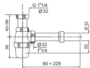
SIPHON réglable en hauteur sortie Ø 40
