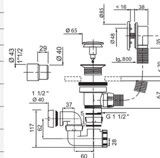
**Vidage avec siphon orientable L700 mm sortie Ø 40**
