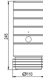
**BAGUE avec joint de sortie de cuvette**
