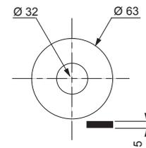
**M61 Joint de clapet J. Delafon**
