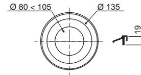
**BAGUE avec joint de sortie de cuvette**
