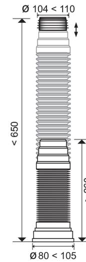
PIPE EXTENSIBLE avec armature métallique
