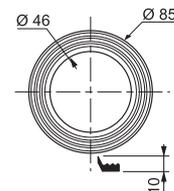
**M25 Joint de clapet standard**
