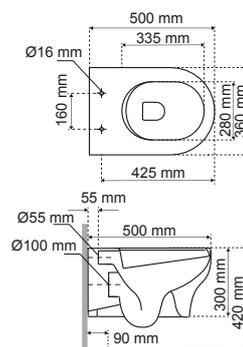
Cuvette GLASSY + abattant GLASSY thermodur SOFT CLOSE, sans rebord, déclipable, frein de chute
