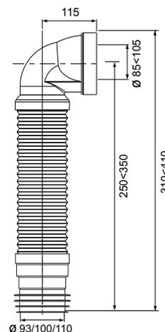
PIPE EXTENSIBLE avec armature métallique - Push-Fit ou à coller
