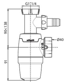
SIPHON réglable en hauteur sortie Ø 32 + tube de sortie murale
