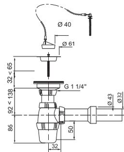
**SIPHON réglable en hauteur et bonde à bouchon**
