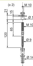
Ensemble fixation réservoir/cuvette, 15 pièces
