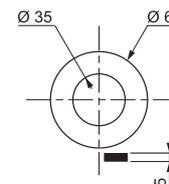
**M42 Joint de clapet 35 x 70 x 6**
