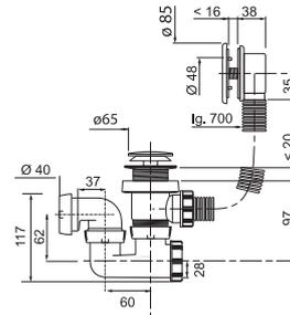
**Vidage avec siphon orientable L800 mm sortie Ø 40/43**
