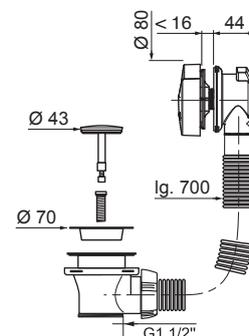
**Vidage avec siphon orientable L1300 mm sortie Ø 40/43**
