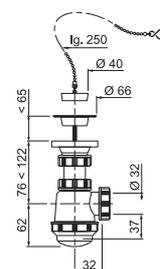
**SIPHON LAITON réglable en hauteur et bonde à bouchon avec tube de sortie murale**
