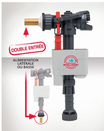
Le robinet flotteur DOBLO, grâce à son système ingénieux d'embout amovible, s'adapte aux réservoirs avec alimentation en eau latérale ou basse. De plus, sa technologie de remplissage différé permet une économie d'eau jusqu'à 6L par jour (pour une famille de 4 personnes).
