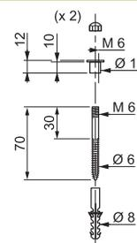
M21 Jeu de vis métal cuvette-réservoir
